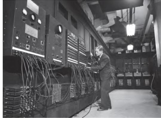
**كما أن أحجام الحواسيب** كانت ضخمة جداً؛ فهي تحوي الكثير من الأسلاك والترانزستورات، كما هو موضح في الصورة أعلاه. وكانت سرعة مرور التيار الكهربائي خلال هذه الأسلاك لا يتجاوز  $\frac{2}{3}$  سرعة الضوء. وبسبب طول الأسلاك المستخدمة فإنه يلزم التيار الكهربائي فترة زمنية طويلة ليمر خلالها.
